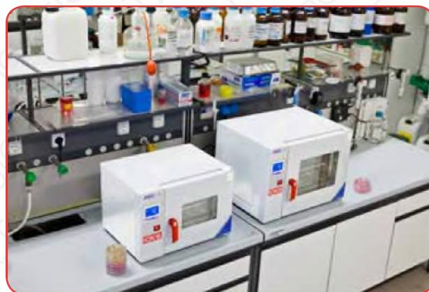
Per una migliore uniformità della temperatura, il sistema di riscaldamento a filo è posizionato su tutta la superficie delle pareti della camera.
