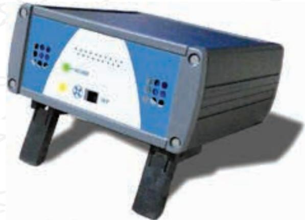
Lo ionizzatore possiede due aghi conduttivi che alimentati ad un'alta tensione producono ioni con carica positiva e negativa. Questi ioni sono attratti dal materiale di pesatura elettrostaticamente caricato, neutralizzano così il carico elettrostatico disturbante. Neutralizzando le cariche elettrostatiche scompaiono le forze che falsificano la pesatura (es. risultato pesatura errato, instabilità).
